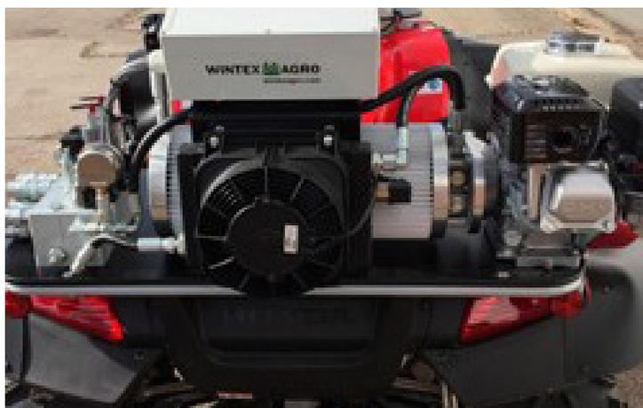
Il serbatoio dell'olio è fatto su misura in alluminio. Ha una superficie a coste che permette un rapido e migliore raffreddamento. Alluminio e superficie a coste permettono una capacità di raffreddamento fino a 12 volte più veloce ed efficace.
