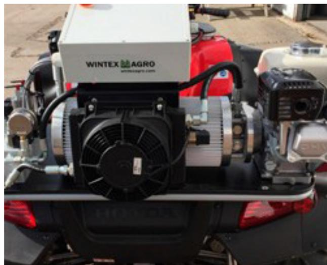
Il serbatoio dell'olio è fatto di alluminio su misura. Ha una superficie a coste, ciò significa che la sua area è tre volte più grande di una superficie piana. A causa dell'alluminio e della superficie a coste, la capacità di raffreddamento è 12 volte superiore alla capacità di raffreddamento di un tradizionale serbatoio dell'olio.
