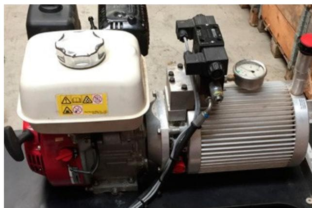
L'impianto idraulico realizzato su misura per adattarsi al Wintex 1000. azionato da un motore Honda GX160.
