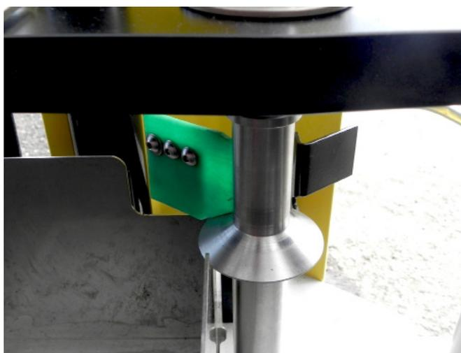
Il raschiatore si adatta perfettamente al diametro interno della sonda e le lame raschianti assicurano che la sonda sia completamente svuotata prima di tornare a terra.
