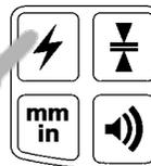
Premere il pulsante d'alimentazione elettrica per accendere il ricevitore. Tenere premuto per 2 secondi il pulsante d'alimentazione elettrica per spegnere il ricevitore.
