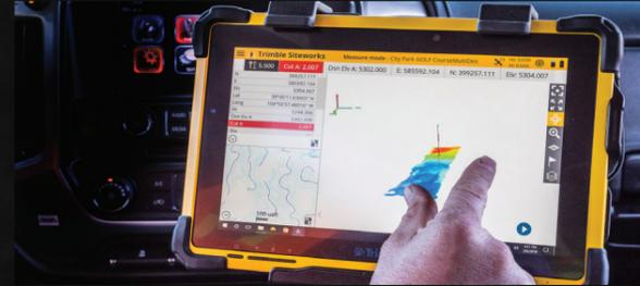
Il **sistema di posizionamento Siteworks di Trimble per Capicantiere** comprende la Smart Antenna GNSS SPS986 o SPS785, il tablet T7 o T10 e il software Siteworks. Il capocantiere può gestire pacchetti software per ufficio completi, compresi Business Center - HCE e Microsoft Office, e in più può gestire in tutta semplicità dati e modelli tridimensionali in cantiere senza portare con sé un PC portatile.
